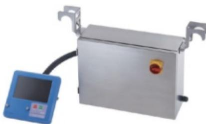
В новейшем цифровом датчике нагрузки реализована технология высокоскоростной обработки сигнала, что позволяет чеквейеру работать на скоростях до 320 уп./мин., сохраняя при этом отличные метрологические характеристики, такие как повторяемость  $\pm 0.08$  г (3σ) и дискретность 0,01 г при НПВ до 500 г.
